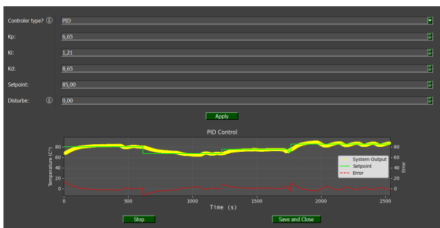
Figura 11. Monitoramento de um controlador PID aplicado ao módulo de temperatura
