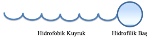
Şekil 2. 31. Yüzey aktif madde molekülünün yapısı
