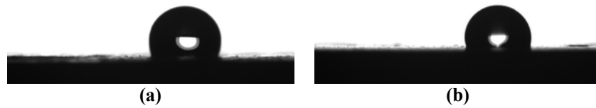
Şekil 4. 31. Farklı paslanmaz çeliklerin 40 g FeCl 3 +100 ml H 2 O + 1,2x10 -3 M CTAB ile kimyasal işlem sonrası temas açısı görüntüleri (a) AISI304 ve (b) AISI 316
