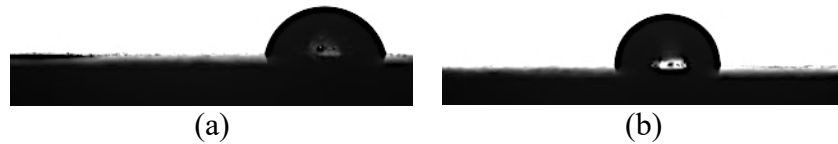
Şekil 4. 34. Paslanmaz çelik numunelerin 40 g FeCl 3 +100 ml H 2 O + 20 ml HNO 3 ile kimyasal işlem sonrası temas açısı görüntüleri (a) AISI304 (b) AISI 316
