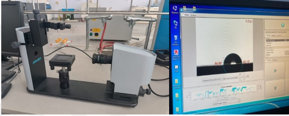
Şekil 3. 10. Temas açısı ölçüm cihazı
