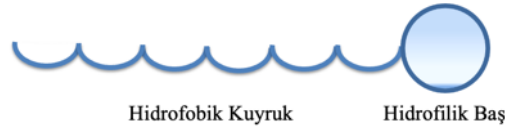
Şekil 2. 36. Noniyonik yüzey aktif madde molekül yapısı
